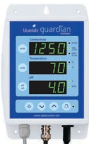
Geslaagde kalibratie pH7 en pH4
