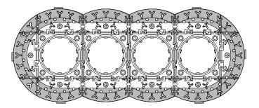
USE PLASTERBOARD GLUE ALL AROUND FLANGE BORDER (DO <u>NOT</u> USE SILICONE ADHESIVE)
