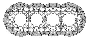
USE PLASTERBOARD GLUE ALL AROUND FLANGE BORDER (DO NOT USE SILICONE ADHESIVE)
