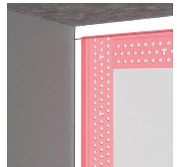
**Junta ingleteada de Hotrod XL horizontal a esquinero Fire Bead vertical:**
